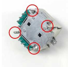
図 2 配布ジョイスティックの切断箇所
