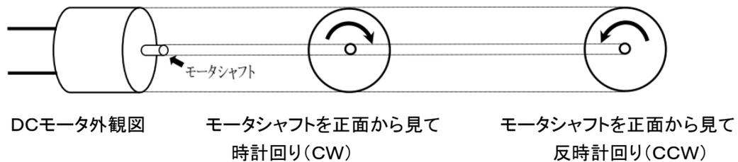
(8) ステッピングモータの回転方向は、シャフトを上から見て、時計回りを正回転 (CW)、反時計回りを逆回転 (CCW) とする。また、回転速度は任意とする。
