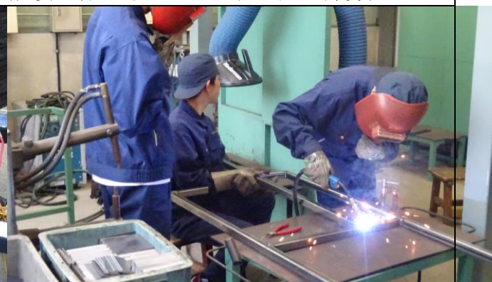
溶接の様子(フレーム製作時)
